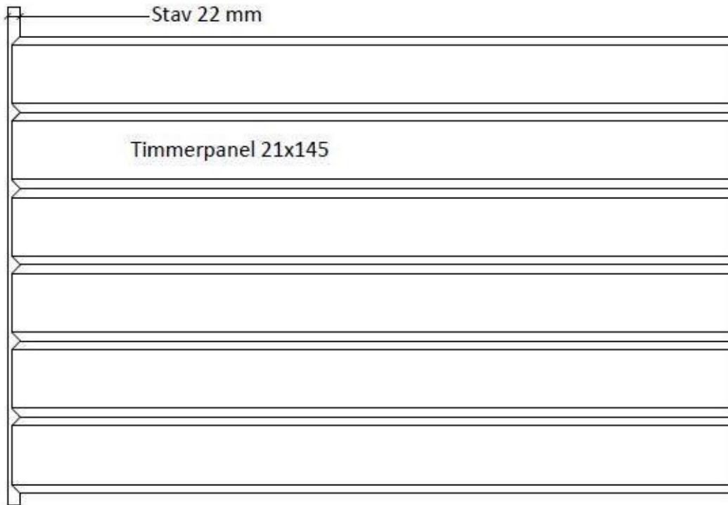
Fig. 17 Montering av timmerpanel
